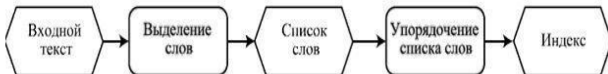
Рисунок 10 - Архитектура индексатора в стиле «каналы и фильтры»
